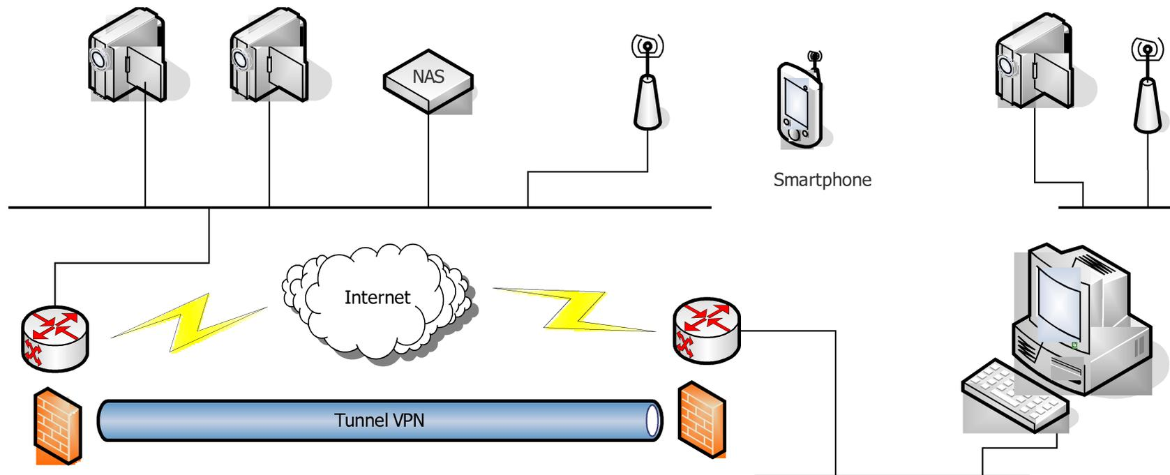
Una (o più) videocamere collegate ad una rete LAN, una (o più) videocamere collegate via wireless;
